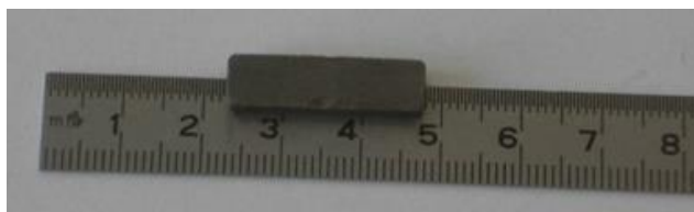
Obr. 3 Příklad provedení segmentu permanentního magnetu
