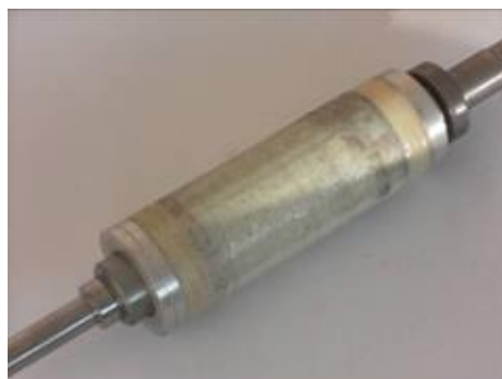
Obr. 4 Příklad provedení rotoru motoru SPMSM
