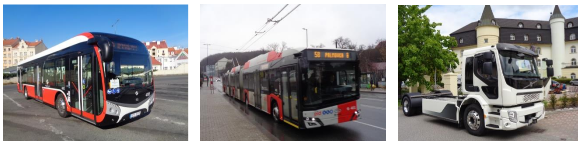
Obr. 8 Příklady těžších elektrických silničních vozidel – elektrobuse SOR, parciální trolejbus Solaris/ŠKODA a tahač VOLVO.
