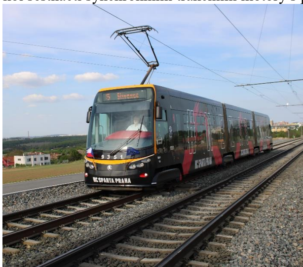
Obr. 5 Tramvaj ŠKODA 15T se šestnácti trakčními synchronními trakčními motory s permanentními magnety, jmenovitý výkon jednoho motoru je 46 kW
