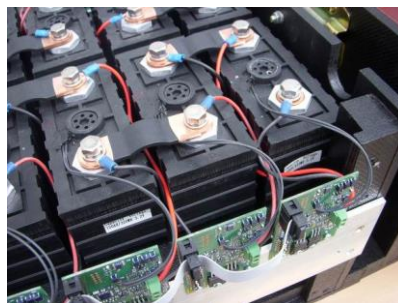
Obr. 7 Zapojení batterymanagementu s balancery a centrální řídicí jednotkou batterymanagementu (a)) a příklad realizace balancerů u akumulátorových článků LFP (b) vlevo) a LTO (b) vpravo)
