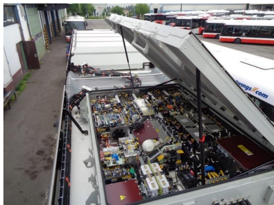
Obr. 8 Příklady provedení bateriové výzbroje vozidla – bateriový kontejner na střeše tramvaje, bateriový box v elektrobusu a měničový (v popředí) a bateriový (vzdálenější) kontejner a odkrytý bateriový kontejner na střeše parciálního trolejbusu,
