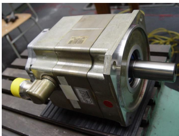
Obr. 9 Příklad provedení synchronního servomotoru s permanentními magnety 5 kW
