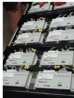
Obr. 8 Příklady provedení bateriové výzbroje vozidla – bateriový kontejner na střeše tramvaje, bateriový box v elektrobusu a měničový (v popředí) a bateriový (vzdálenější) kontejner a odkrytý bateriový kontejner na střeše parciálního trolejbusu,
